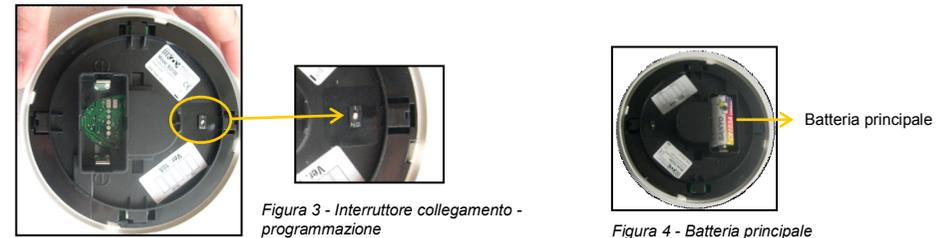
Figura 3 - Interruttore collegamento - programmazione
